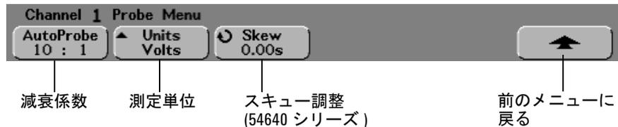
**プローブの減衰係数** アナログ・チャンネルに AutoProbe 自己感知プローブ (10073C や 10074C など) を接続すると、オシロスコープは、正しい減衰係数に合わせてプローブを自動的に設定します。前の図では、オシロスコープが AutoProbe 10:1 プローブを検知しています。
