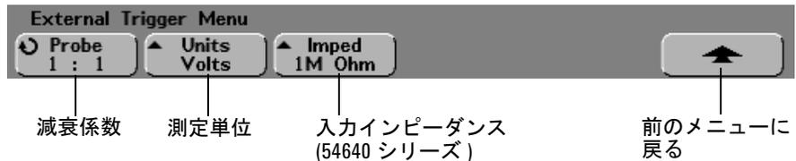
**プローブの減衰係数** 接続されているプローブの **[Probe]** ソフトキーに表示される減衰係数を設定するには、**Entry** つまみを回します。減衰係数は、0.1:1 ~ 1000:1 の範囲内で、1-2-5 のシーケンスで設定できます。
